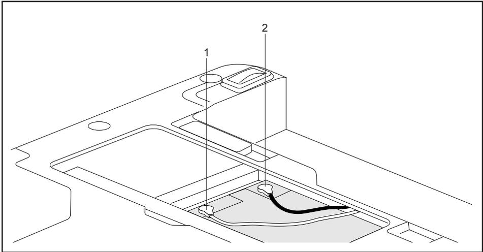
Die Punkte kennzeichnen die Positionen zum Anschluss der beiden Antennen am UMTS/LTE-Modul (1: orange; 2: gelb).
